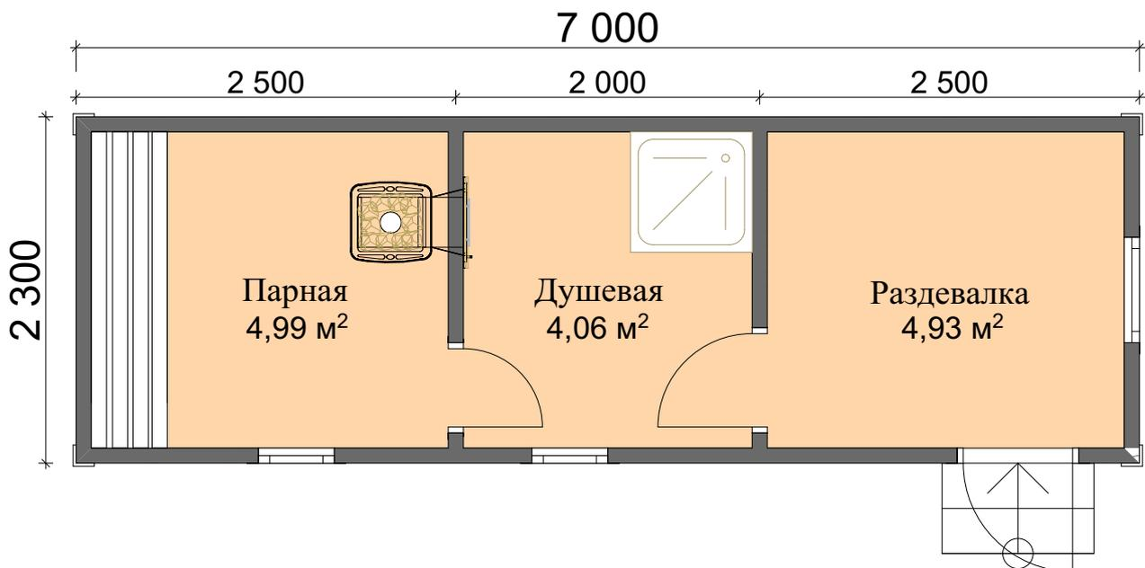
Габаритные размеры: 7х2,3м. Площадь застройки: 16,1м<sup>2</sup>. Общая площадь: 13,98м<sup>2</sup>.
