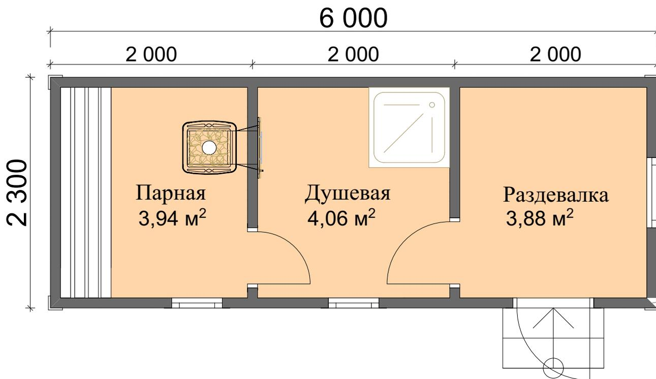
Габаритные размеры: 6х2,3м. Площадь застройки: 13,8м<sup>2</sup>. Общая площадь: 11,89м<sup>2</sup>.
