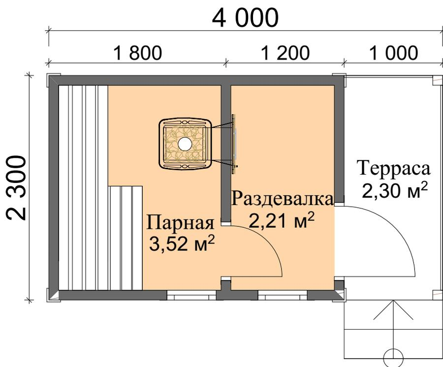
Габаритные размеры: 4х2,3м. Площадь застройки: 9,2м<sup>2</sup>. Общая площадь: 8,03м<sup>2</sup>.
