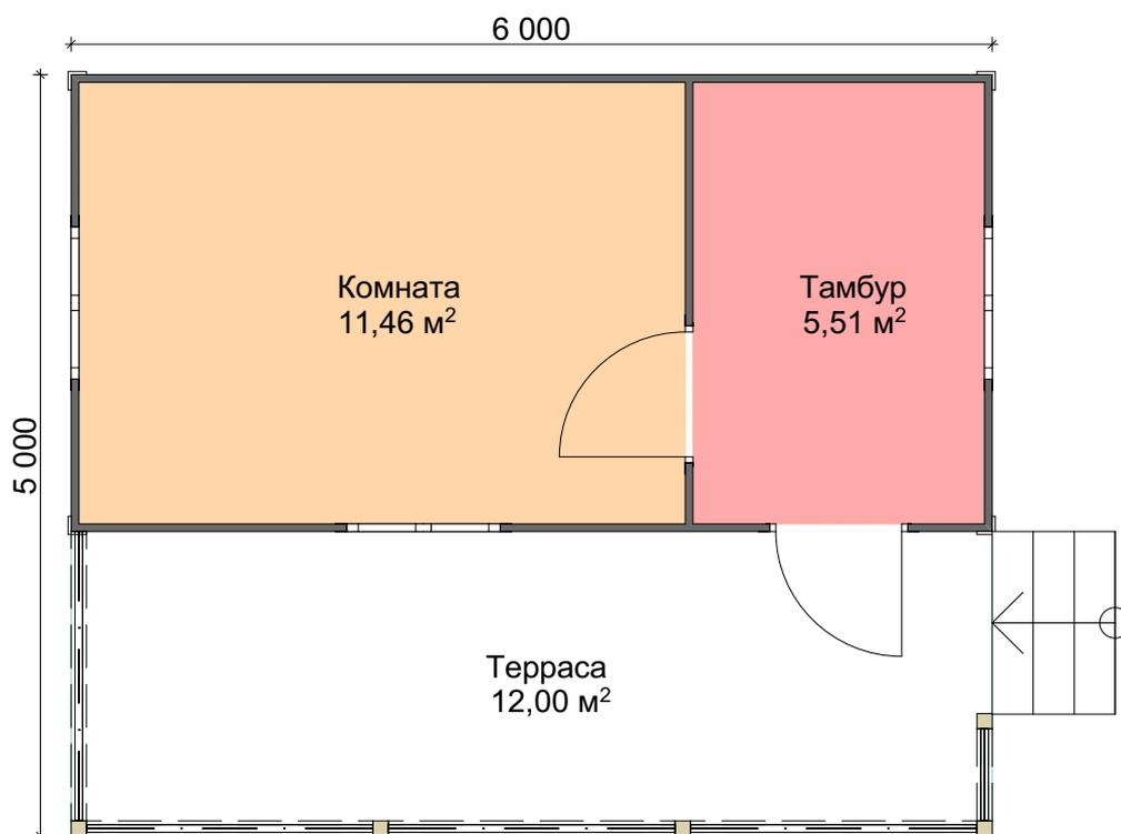
Габаритные размеры: 6х5м. Площадь застройки: 30м<sup>2</sup>. Общая площадь: 28,97м<sup>2</sup>.
