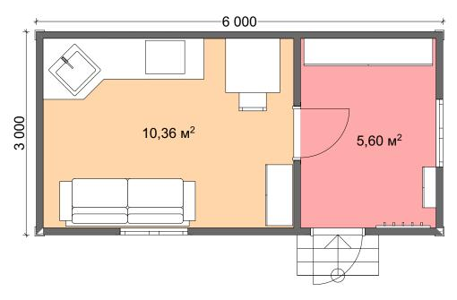
Габаритные размеры: 3x6м. Площадь застройки: 18м $^2$ . Общая площадь: 15.96м $^2$ .
